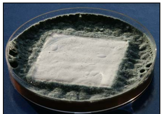
Bild 6.2: Mit Schimmelschutz gestrichene Probe im Eingießversuch nach 21-tägiger Bebrütung
