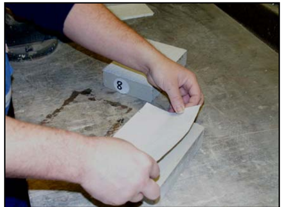
Bild 4.2: Belegung einer Porenbetonprobe mit Tapete
