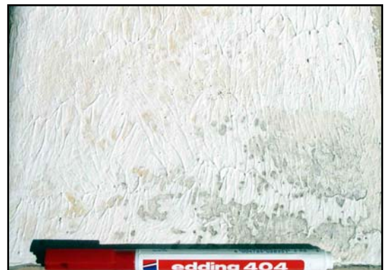
Bild 6.2: Mit Schwärzepilzen bewachsene GK-Probe nach 18-monatiger Bebrütung. Die gelb umrandeten, verfärbten Bereiche sind nicht bewachsen.
