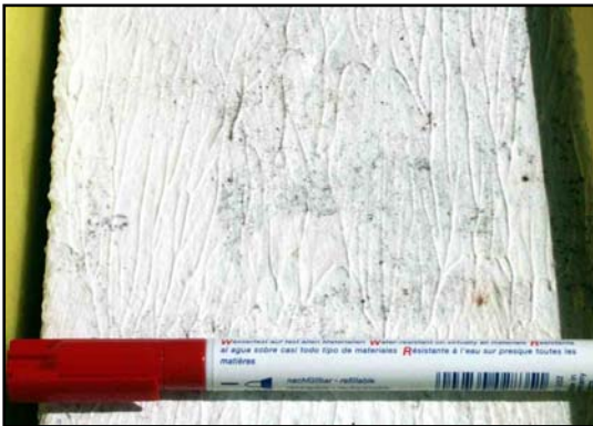
Bild 6.1: Mit Schwärzepilzen bewachsene Porenbetonprobe nach 18-monatiger Bebrütung.
