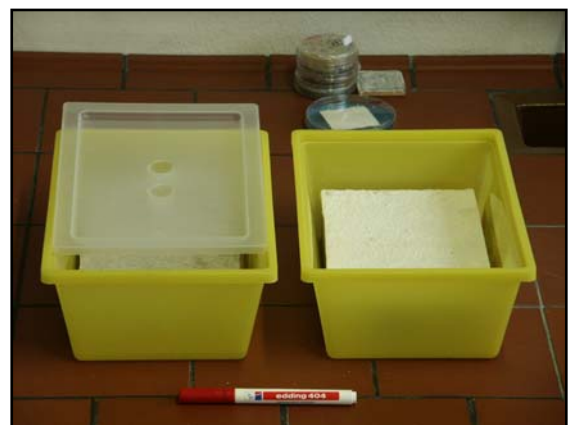
Bild 4.4: Porenbeton-Proben in Transportbehältern
