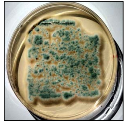
Bild 7.3: 18 Monate nach Überstreichen mit Schimmelschutz. Einzelkolonien sind unterscheidbar - Bewuchsdichte vermindert.
