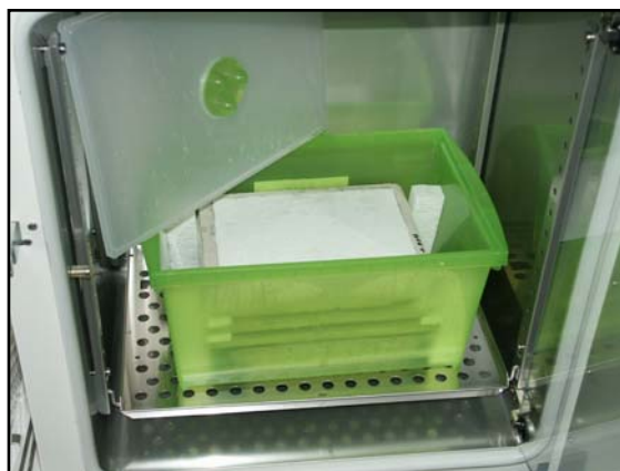
Bild 4.3: Bebrütung der GK-Platten in Transportbehältern
